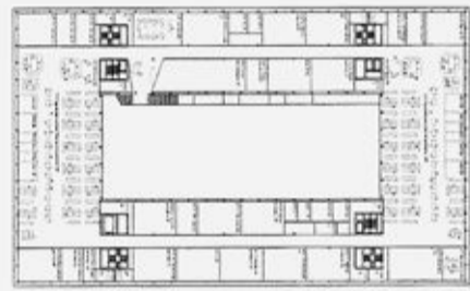
«Tatoro», die grosse Halle: Grundriss des dritten Obergeschosses. Die technokratische Vernunft legt alle Nutzungen in einen Ring um die grosse Halle. Es ist ein «fertiges» Konzept, das nur in der Längsrichtung erweiterbar ist.
